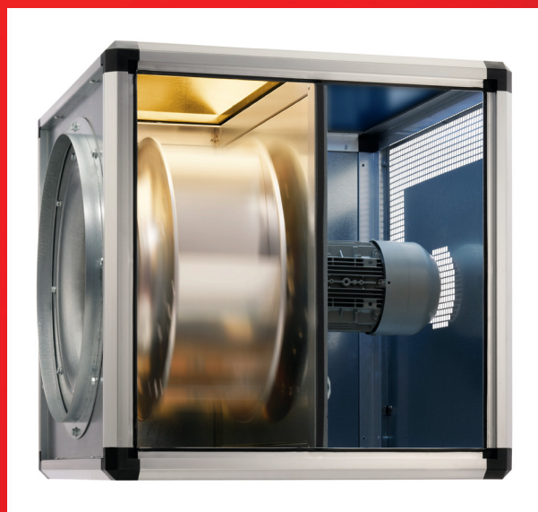
W typie GB T120 silnik znajduje się poza strumieniem powietrza. Izolowana termicznie przegroda jest jednocześnie płytą nośną zespołu silnika z wirnikiem
