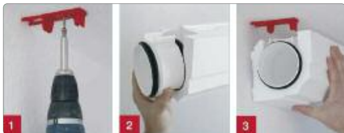
Fot. 2. Zdjęcia przedstawiają kolejność montażu elementów systemu RenoPipe firmy Helios.
